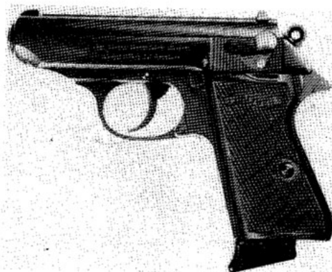
La Walther PPKS calibro 9 corto. Questo modello (in sostanza si tratta di canna e carrello della PPK adattati al castello della PP) è stato realizzato per aggirare le norme che impediscono l'importazione negli USA di pistole di ridotte dimensioni.
